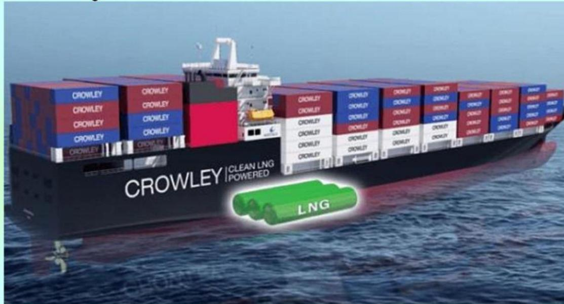
Спроектирован для максимизации перевозки 53-футовых контейнеров шириной 102 дюйма, которые обладают наиболее высокой объёмной вместимостью в сфере торговли. Судно длина 219,5 м, ширина 32,3 м, имеет осадку 10 м и приблизительный дедвейт 26 500 мт. Грузовместимость будет, примерно, 2 400 TEU (20-футовый эквивалент) с дополнительным пространством
