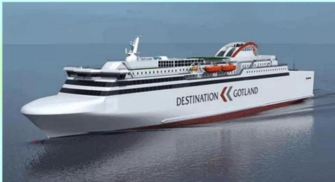
Скоростной паром типа РоПакс с силовой установкой на СПГ, строящийся для шведского оператора Rederi AB Gotland, будет работать на СПГ и будет характеризоваться наличием комплексных технологий Wärtsilä. Работая на СПГ, новый 200-метровый паром будет соответствовать требованиям Tier III
