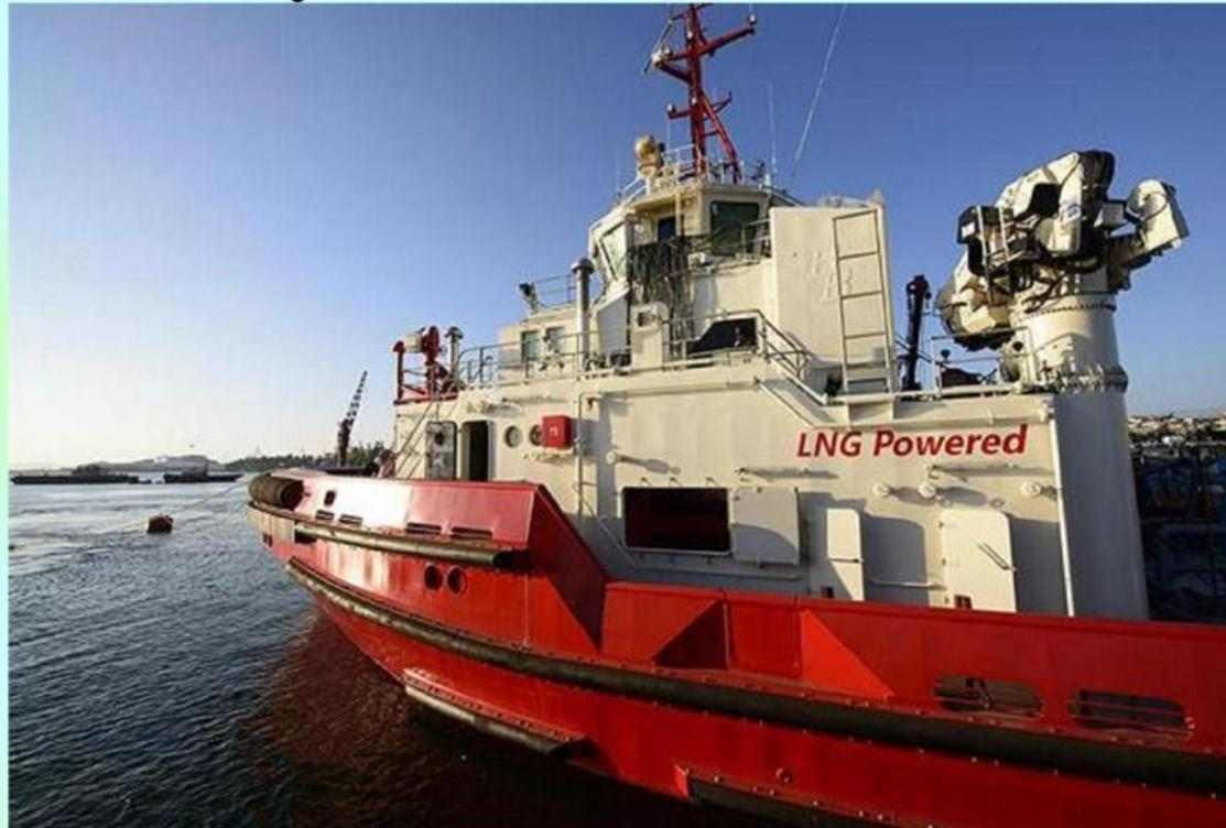
В качестве силовых установок использованы по два двигателя от Rolls-Royce Bergen, работающих на обедненных смесях, с общей выходной мощностью 3410 кВт при 1 000 об/мин. Двигатели имеют прямое подключение к азимутальному Z-
