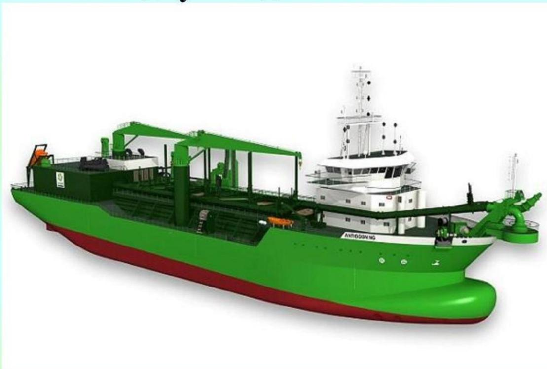
Длина 104 метра, судно имеет бункер вместимостью 8 000 кубических метров. Силовые энергетические установки включают один 12-цилиндровый и один 9-цилиндровый
